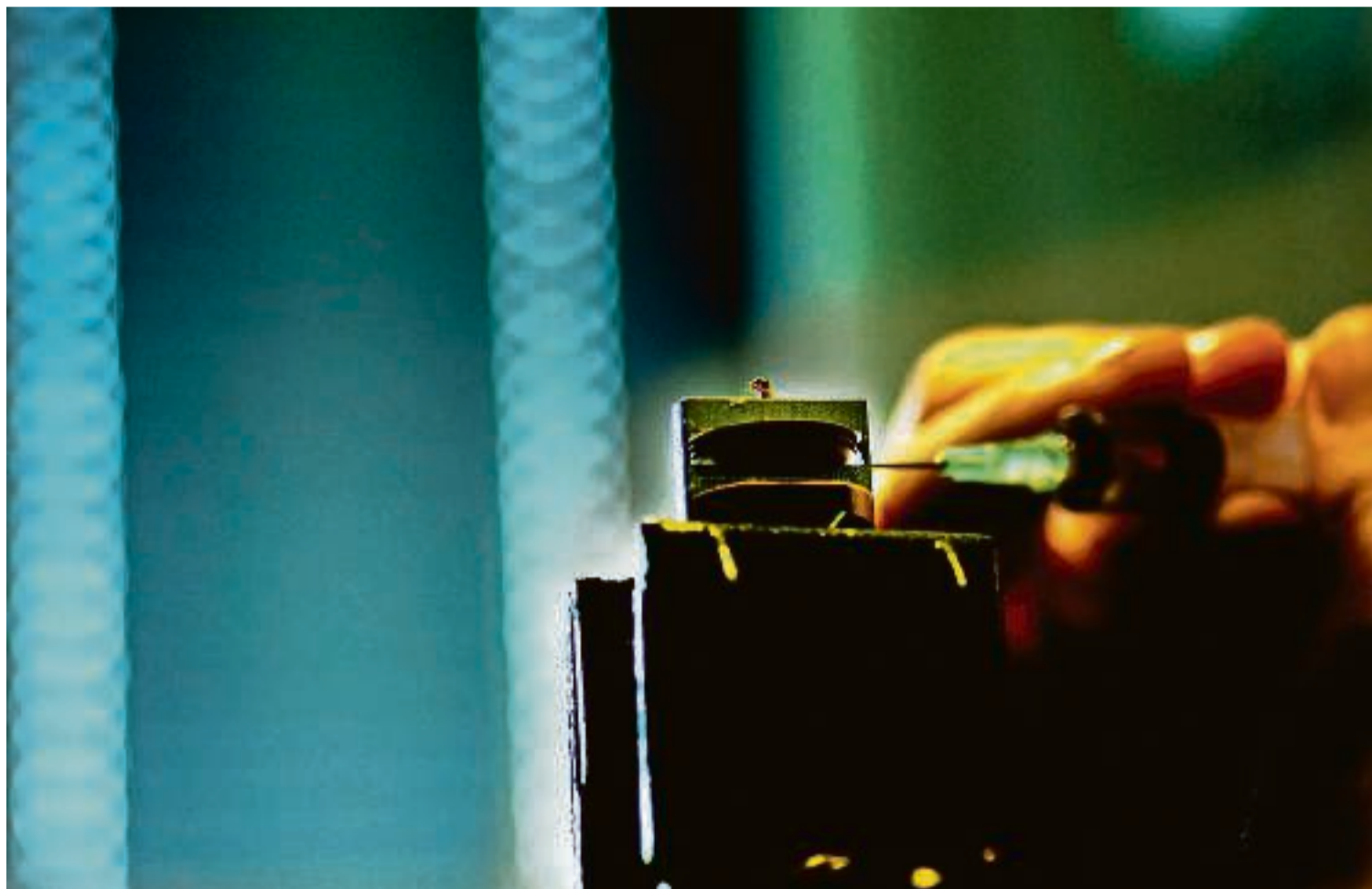
Der sprøjtes væske ind i en »piezo-keramisk inducer« – et af de apparater, som fysikerne på RUC bruger til at måle viskositeten i en væske under forskellige påvirkninger. FOTO: HANNE ENGELSTOFT
